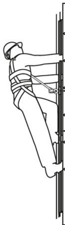
Figura 10. Exemplo de sistema baseado em linha de ancoragem vertical rígida instalada de forma permanente. Fonte: NBR 16489
