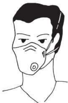
Figura 5.15 - Protetor respiratório com válvula de exalação, tipo dobrável.
