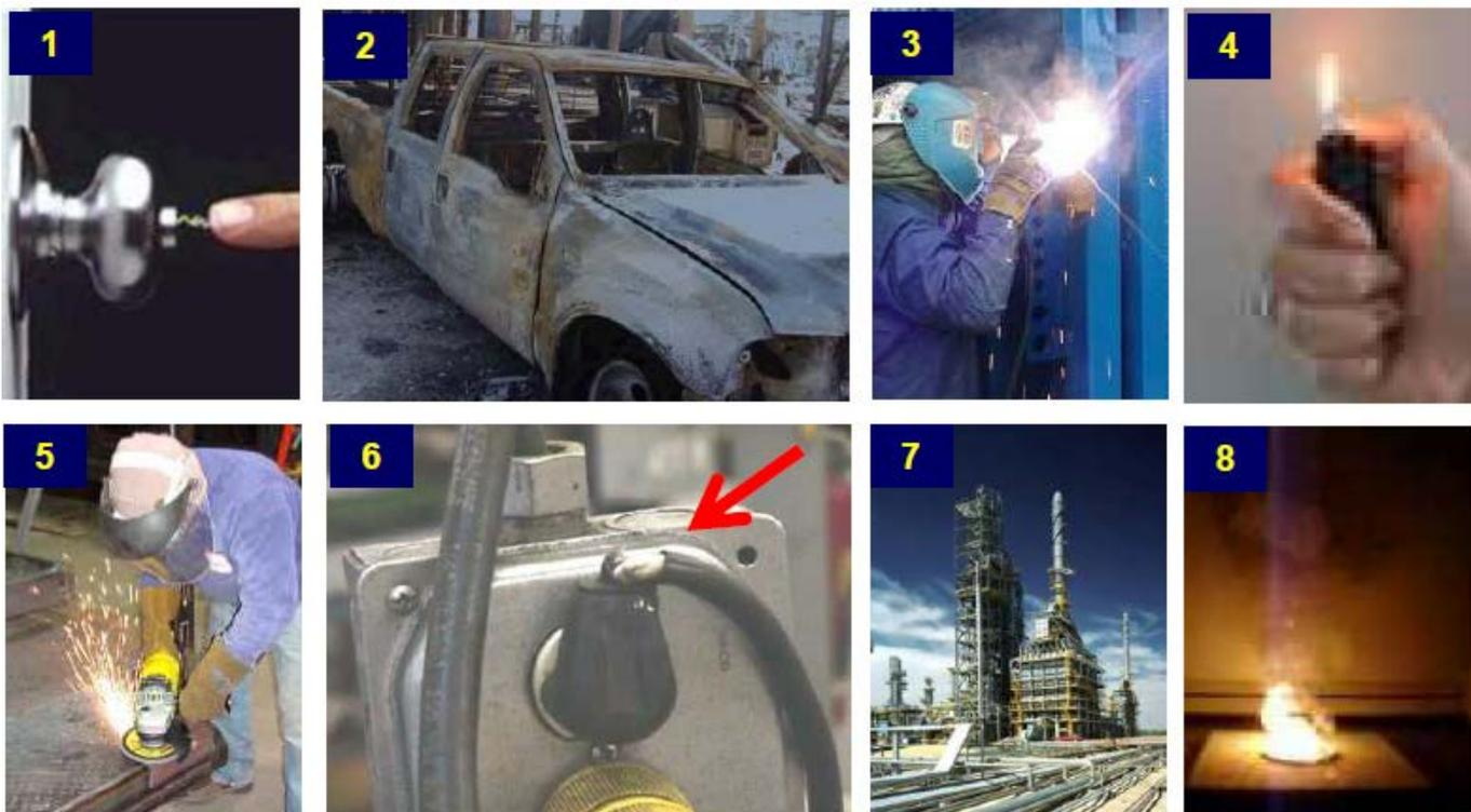
Alguns exemplos de fontes de ignição: (1) eletricidade estática, (2) veículo, (3) soldagem, (4) chama aberta, (5) lixamento ou desgaste, (6) fiação elétrica danificada, (7) um forno, (8) material pirofórico ou em decomposição
