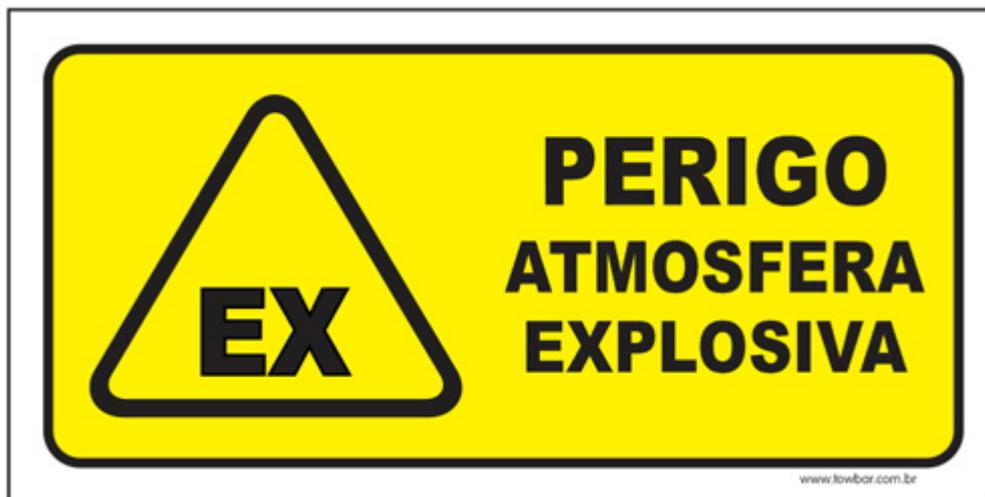
É a mistura proporcional entre o OXIGÊNIO e GASES, VAPORES ou POEIRA INFLAMÁVEIS/COMBUSTÍVEIS, capaz de causar fogo/explosão, quando em contato com Fonte de Ignição
