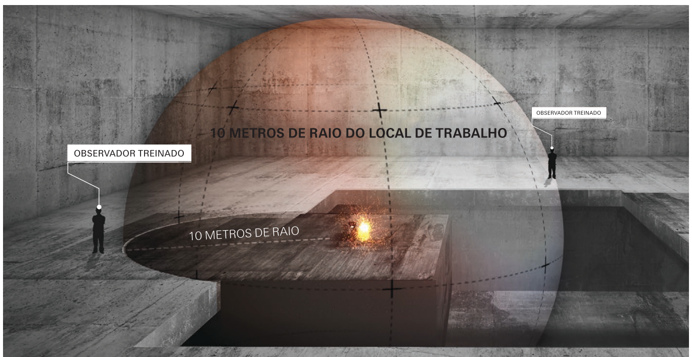
Local de execução do trabalho a quente
