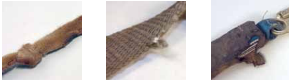
EPIs sem condições de uso
